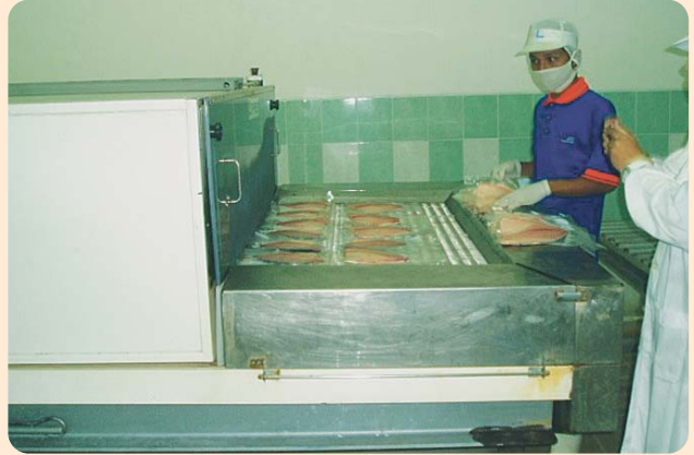
LSP社の加工場（出荷用の液体窒素凍結装置）
