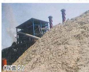
るため、発酵、蒸留、貯蔵設備を新設している。副産物の絞りかす(バガス)は、発電用ボイラー燃料(写真2)となり、余った電力は販売している。砂糖の製造過程で出るフィルターケー
