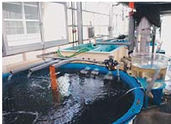
図7 沖縄県が陸上養殖対象としているヤイトハタ(*Epinephelus malabaricus*、写真上)と、沖縄県栽培漁業センターの高密度養殖を実現した半閉鎖循環式陸上養殖システム（写真下）
