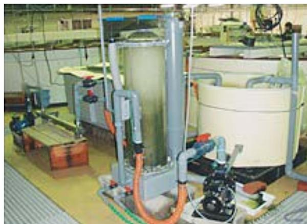
図6 広島県に設置した普及タイプの閉鎖循環式種苗生産システム
