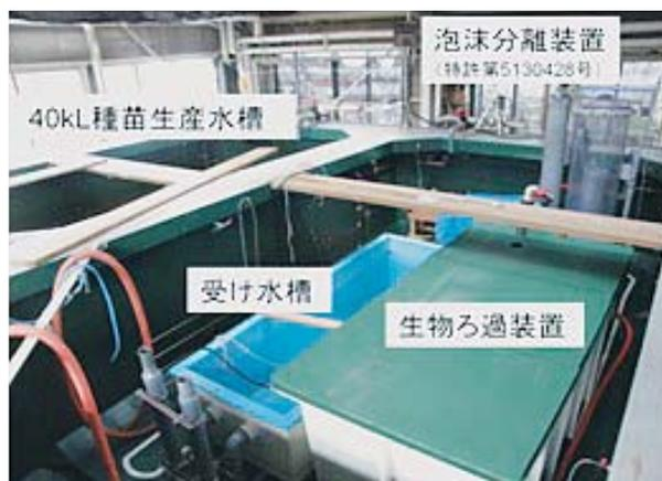
図8 香川県に設置した閉鎖循環飼育システム
